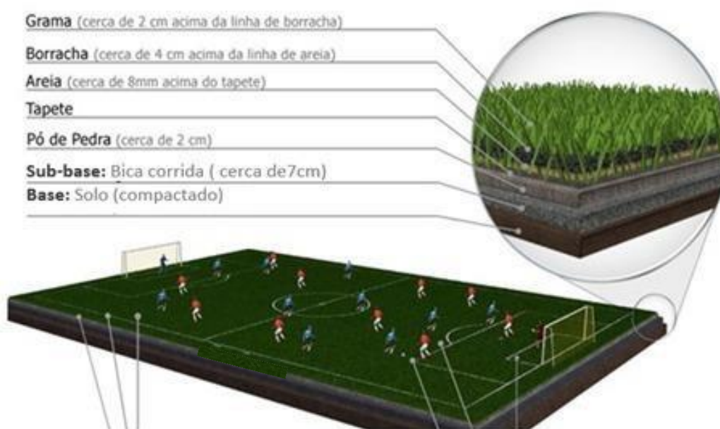
Figura 08– Detalhe Ilustrativo de Instalação e Revestimento (Gramma Sintética) (Fonte: Adaptado brasgrama/2021)
